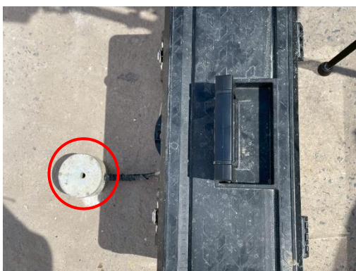
รูปที่ 3.15 การตรวจวัดความสั่นสะเทือน จุดที่ 1 บริเวณพื้นที่ก่อสร้าง ด้านที่อยู่ใกล้อาคารข้างเคียงมากที่สุด
