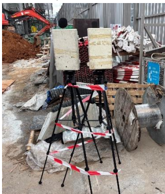
รูปที่ 3.8 การตรวจวัดระดับเสียงโดยทั่วไป และระดับเสียงรบกวน บริเวณพื้นที่ก่อสร้าง ด้านที่อยู่ใกล้อาคารข้างเคียงมากที่สุด
